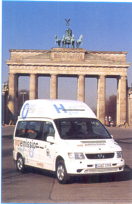
Bild 6: Äußerlich nur noch am Dachaufsatz vom normalen Fahrzeug zu unterscheiden - der NECAR II ist voll verkehrstauglich und erreicht bereits 250 km Fahrtstrecke mit einer Wasserstoff-Füllung (Foto: Daimler-Benz)
