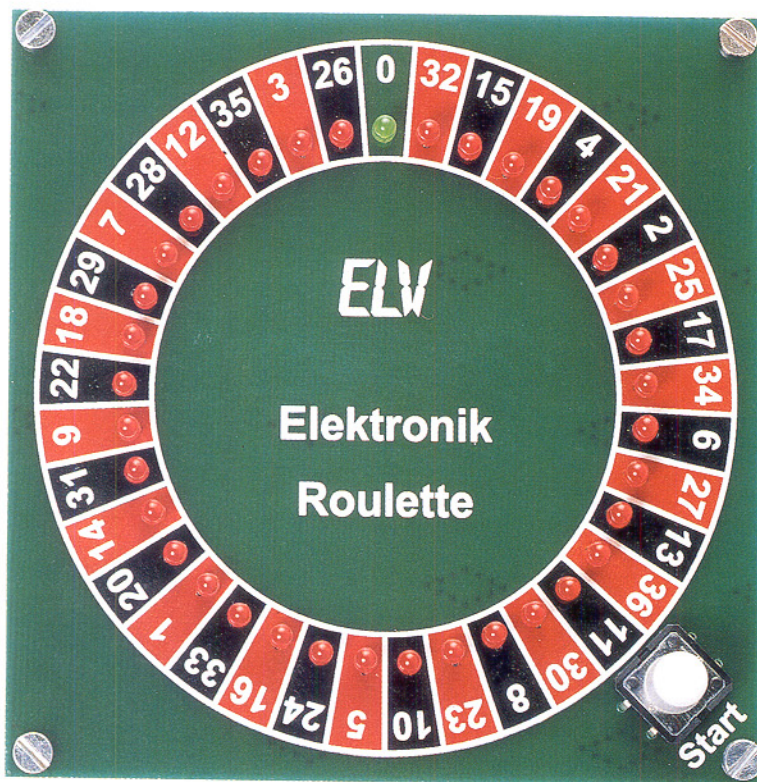
Ansicht der bedruckten Platinenoberseite, die gleichzeitig als Frontplatte dient
